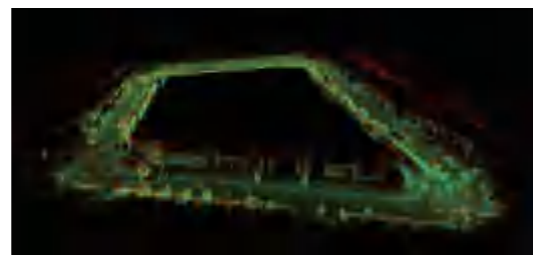
多线激光雷达3D SLAM构建的工厂点云地图
